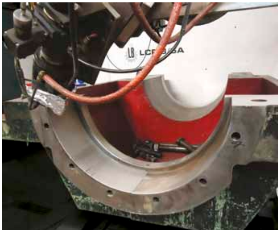
Herstelling van de lagerzittingen, met behulp van het laserlassen van een laag nikkelboor. Arcelor-Mittal opteerde voor deze techniek omdat bussen plaatsen niet voldoende duurzaam werd geacht.
