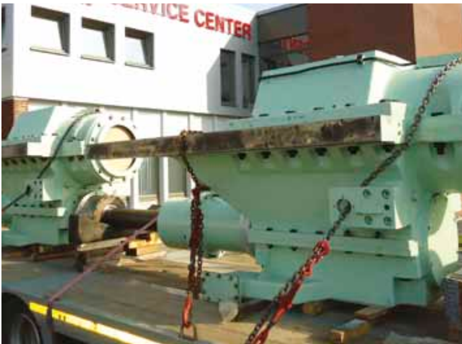
Links: demontage van afwikkelhaspel. Rechts: machine na de revamp.
