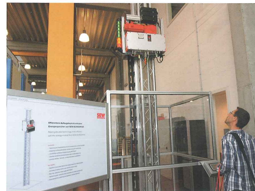
Applications monorails/AGV avec récupération d'énergie power caps
