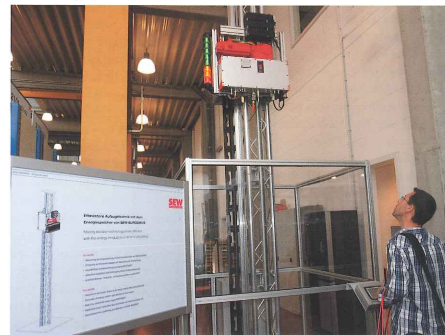
Monorails/AGV toepassingen met recuperatie van remenergie bij liften
